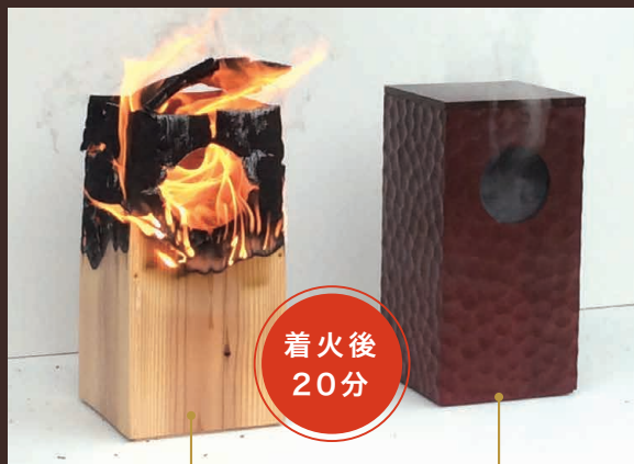
不燃木材に着色し ファイヤーブレイクF4を塗装
